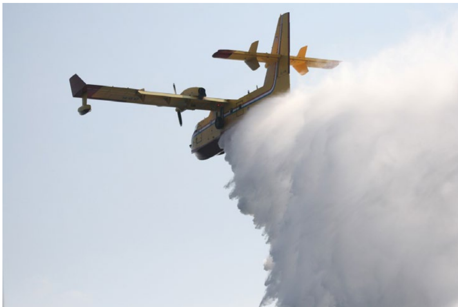
Figura 11. Hidroavión, empleado en la lucha contra incendios, descargando agua.
