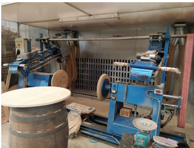
Figura 18. Fotografía de una lijadora automática empleada en la transformación primaria de la madera.
