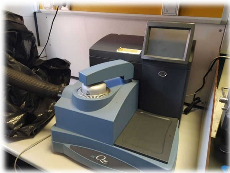
Figura 44. Equipo DSC Q200 de TA Instruments para la realización de calorimetrías diferenciales de barrido.
