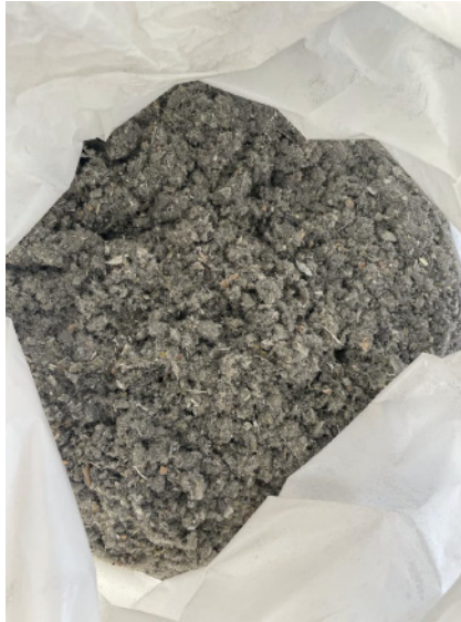
Figura 4. Residuos de techos ya triturados
