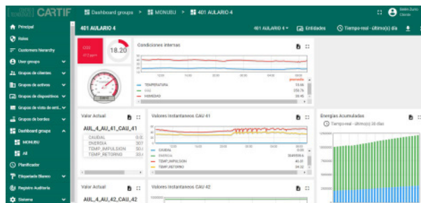
Figura 6. Captura de pantalla del sistema de monitorización.
