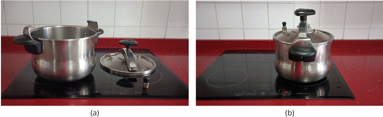
Figura 9.1. Panela de pressão. (a) Componentes: recipiente, tampa e válvula; (b) Conjunto.
