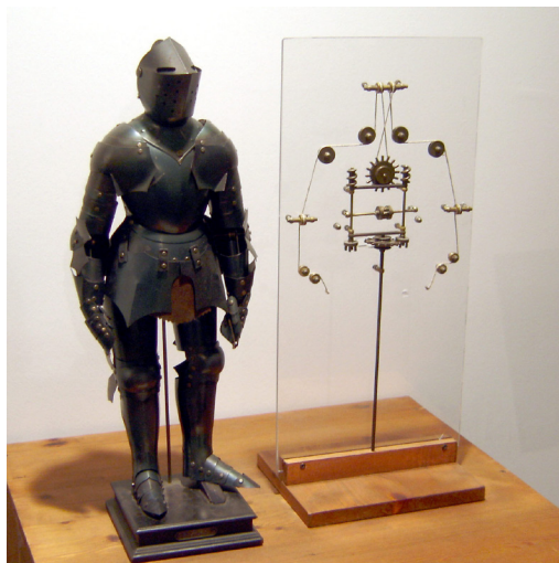
Figura 8.9. Modelo de robô de Leonardo da Vinci com funcionamento interno. Possivelmente construído por Leonardo da Vinci c. 1495.
