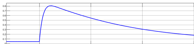
Figura 12. Gráfica de par del motor frente al escalón de 1900-2200.
