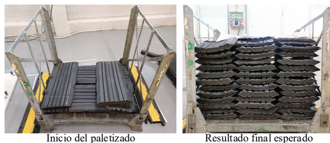
Figura 3 Piezas a paletizar dentro del contenedor metálico en el que paletizarlas. El sistema de visión ha de ver las piezas a paletizar y el contenedor. Fuente: archivo del autor.
